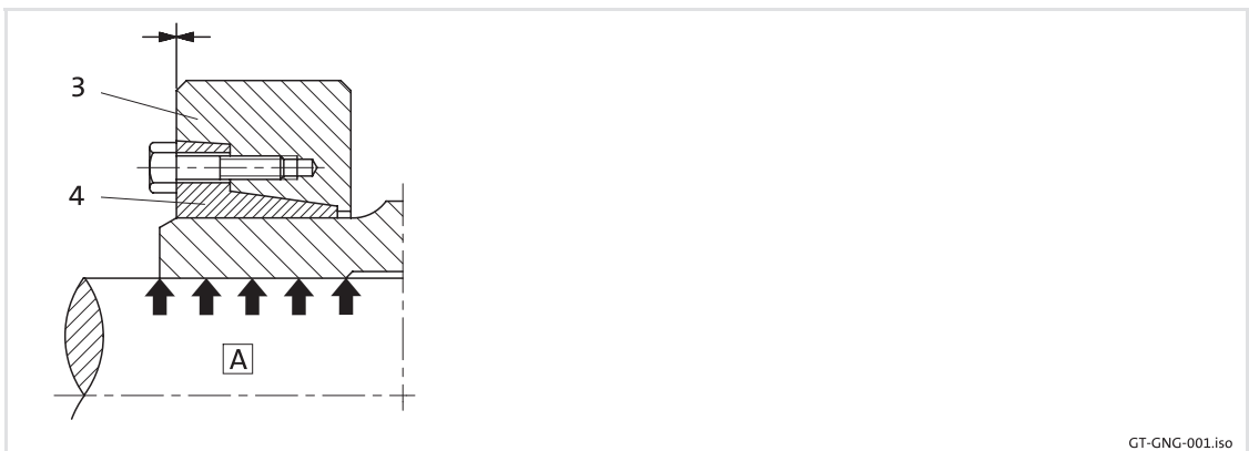
图9 带收缩盘的空心轴 3 外圈 4 内圈
